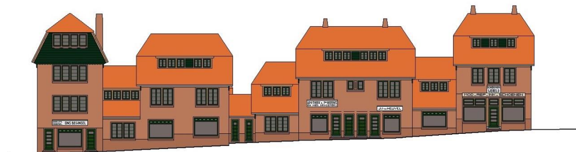
Fig. 1. Twee schematische gevelbeelden van een ensemble in tuindorp 'de Geitenkamp' te Arnhem. Boven het bestaande kleurbeeld en daaronder een hypothetische reconstructie door het architectenbureau op basis van het uitgevoerde verkennende kleurhistorisch onderzoek.
